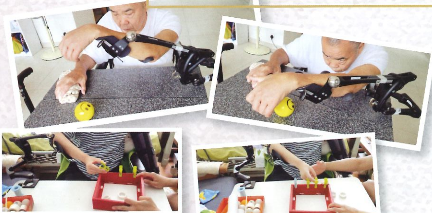
▲ 動力機械手臂 協助個案以較少的力量移動手臂，適合難以提高手臂、運用手部或缺乏氣力人士使用，可以輔助個案進行吃飯、喝水等日常活動。
